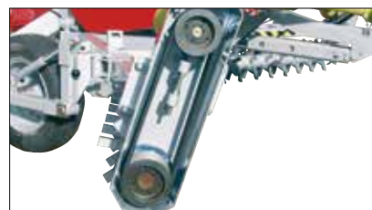
Ременные передачи приводят собирающие грабли.
