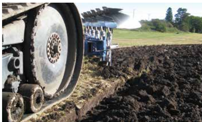
Vari Flex EX On-land parallellförflyttas hydrauliskt för att anpassas till olika traktorbredd, och för justering av första tiltans arbetsbredd.
