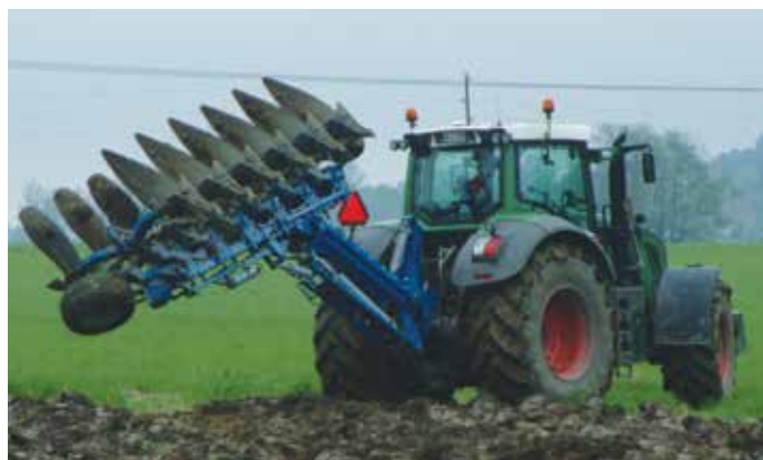
I on-landposition är plogen i balans för växling utan uträtning.
