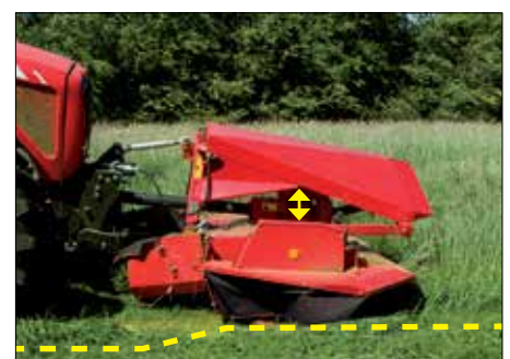
Contour Float - ved ujævn terræn med markforhøjninger.
