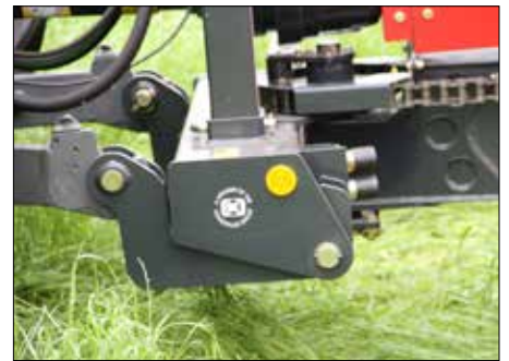
Top Safe sikrer lav stødkraft på knivbjælken ved høj hastighed.
