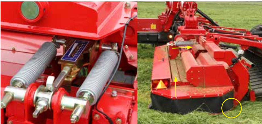
Stubhøjdeindstillingen er integreret med Top Safe.
