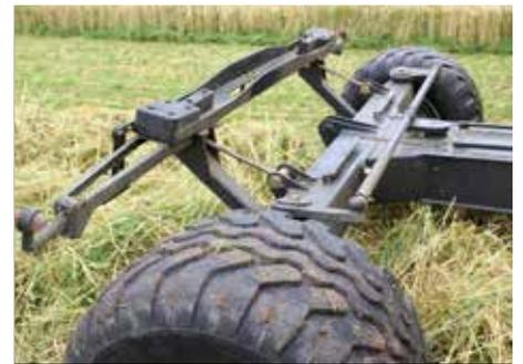
Zwangslenkung der Hinterachse
