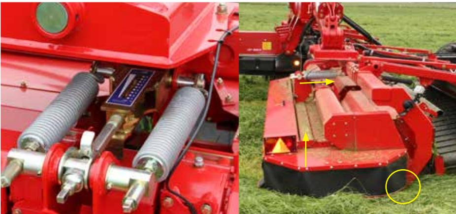
Die Schnitthöheneinstellung ist im Top Safe System integriert.
