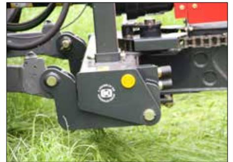
Das Top Safe System reduziert die Belastung des Mähbalkens bei hohen Fahrgeschwindigkeiten.
