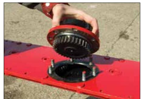
Mit dem Top Service Mähbalken sind die Kontrolle und der Austausch von Zahnrädern und Lagern bei jeder einzelnen Scheibe möglich.
