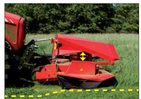
Contour Float - ongelijkmatige bodemvolgung
