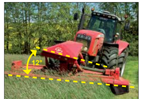
Contour Float - zijwaartse bodemvolgung
