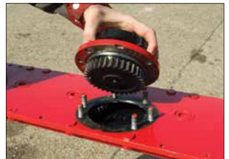
Bij de Top Service maaibalken is controle of vervangen van lagers of tandwielen op elke schijf mogelijk.
