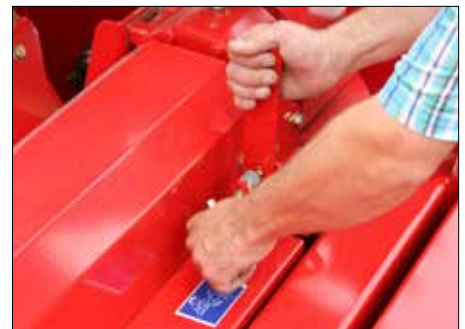
De kneusintensiteit wordt op de PE-kneuzer zonder gereedschap ingesteld.
