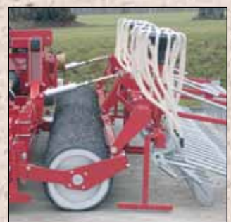
Die präzise Tiefenführung der Schareinheit durch den Packer ermöglicht eine optimale Saatgutablage.
