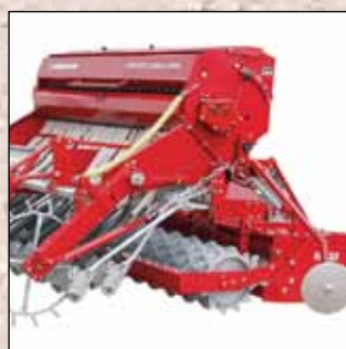
Schwerpunkt nah am Schlepper.
