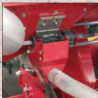
Dosiereinheit mit Zellenrädern.
