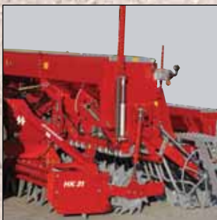
Bei der Arbeit trägt der Packer die Drillmaschine. Die Höhe des Saatkastens und der Tiefenanschlag werden passend zum Packer eingestellt.
