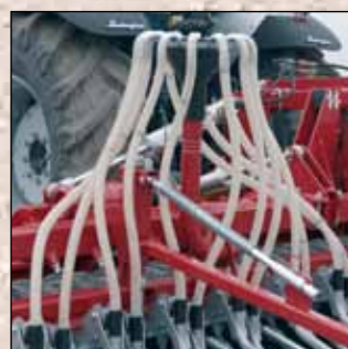
Die gleiche Länge aller Saatschläuche sichert Genauigkeit beim Drillen.
