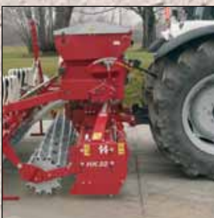
Der großvolumige Saatgutbehälter ist niedrig und nah am Schlepper aufgebaut.
