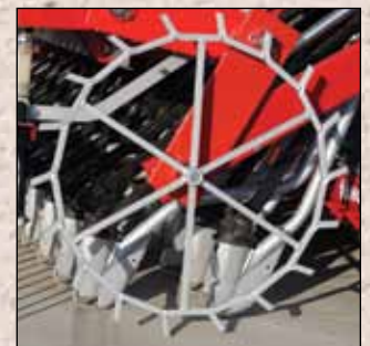
Das große Antriebsrad bewirkt einen sicheren Antrieb der Drillmaschine.
