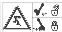
Lorsque les sections de la rampe sont élevées en position de transport, les rampes doivent toujours être fixées avec les verrous de transport mécaniques. Ne pas passer sous une rampe de l'épandeur surélevée.
