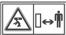
**En aucun cas, on ne peut rester dans la portée de la charge lorsque la trémie est remplie.**
