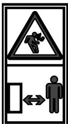
La section extérieure de la rampe de l'épandeur est à ressort lorsqu'elle est pliée. Tous les travaux de maintenance doivent être effectués lorsque la rampe est repliée en position de travail et correctement supportée.
