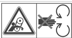
**Arrêter le moteur et retirer la clé avant d'enlever les boucliers de sécurité, il pourrait y avoir un risque d'écrasement des mains lors des travaux d'entretien. Assurez-vous que tout le blindage est correctement en place lorsque l'entretien est terminé.**
