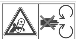
**N'essayez pas de démarrer le tracteur ou d'engager la prise de force avant d'être correctement assis sur le siège du conducteur. Restez à l'écart et éloignez également les vêtements amples de l'arbre de prise de force en rotation.**
