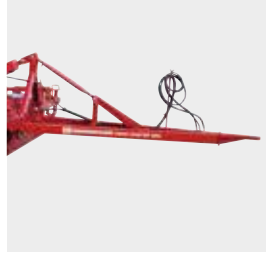
Version arrastrada Todos los modelos se pueden actualizar con una lanza de arrastre y con sistema hidráulico de ajuste de la profundidad.
