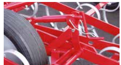
Ajuste de profundidad con husillos con escala.
