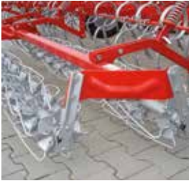
RDGC doble rodillo Para suelos medios o pesados. Tiene un efecto extra de desterronado.
