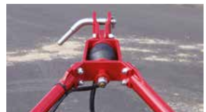
Estabilizador de goma para proteger la máquina y el tractor.
