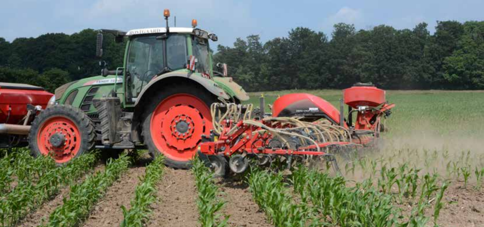
VCOF 8-75 med sektionkontrol – bemærk yderste sektion til venstre er hævet.
