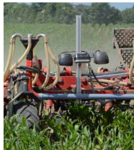
Stereokameraets højde og vinkel kan tilpasses afgrødens stadie.
