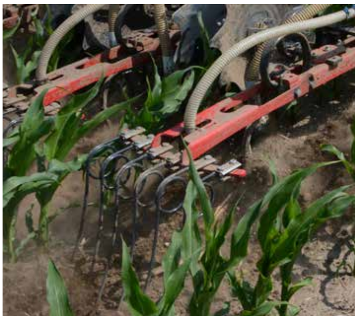
Enkel og robust efterharve som samtidig beskytter spredepladen fra FS Seeder.
