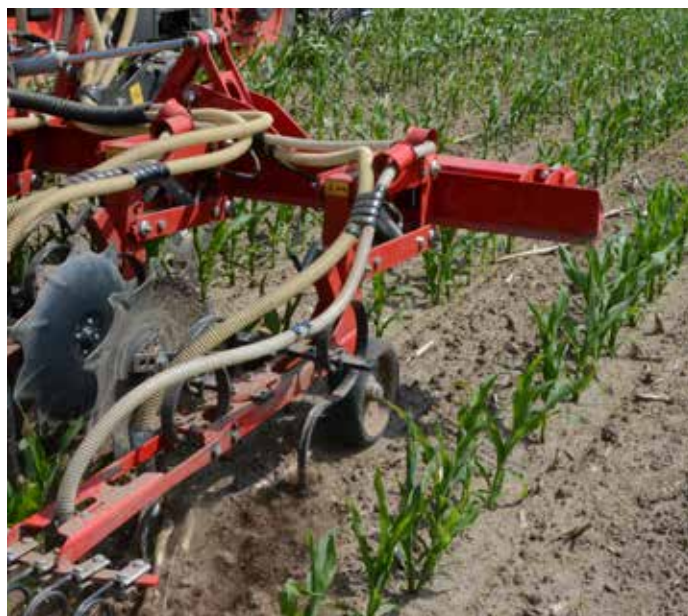
Rensesektioner med originale Kongskilde tænder og skær samt roterende plantebeskyttelsesskjolde sikrer optimal rensning.
