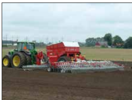
Multi Jet / Combi Jet er beregnet til såhastighed mellem 10 - 15 km/t.
