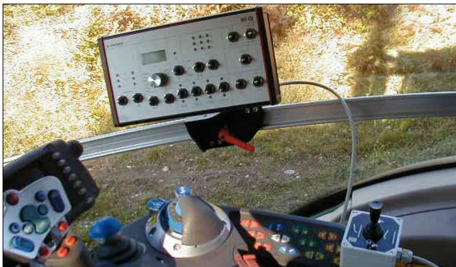
K-Tronic kontrolsystemet gør det muligt at styre udsædsmængderne fra kabinen.
