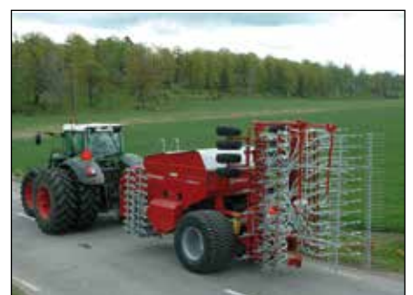
Alle Jet modeller fra 4 til 8 meters arbejdsbredder foldes hydraulisk til 3 meters transportbredder for sikker vejtransport.
