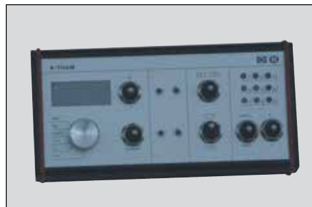
Arealmåling, niveau- og rotationsovervågning samt plejesporsmarkering kontrolleres via K-Tram systemet.
