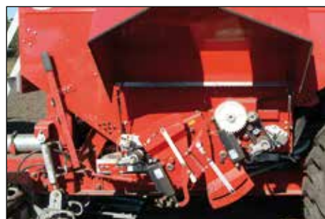
Vario-K gearkasse styret af K-Tronic, gør det muligt at justere udsædsmængden under drift.
