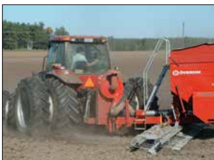
Den nye trækbom styrer maskinen ud i hjørnerne og følger traktoren på foragerne.
