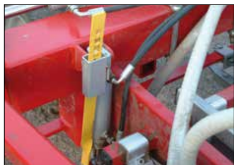
Hydraulisk justering af skærtryk med indikator placeret synligt fra kabinen.
