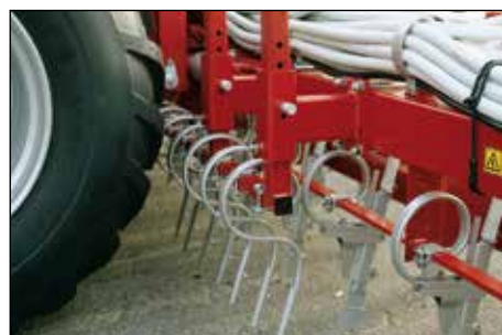
Sporløsnere med en ramme, der er bred nok til at dække traktorens tvillinghjul.
