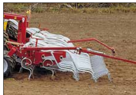
Multi Jet kan udrustes med 2 rækker harvetænder inden skærsektionen. Der harves mellem såskærene.
