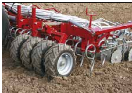
Sidepakkere med 2, 4 eller 8 traktormønstrede dæk kan monteres på hver sidefløj for at opnå pakning i fuld bredde 4, 6 eller 8 meters arbejdsbredde.
