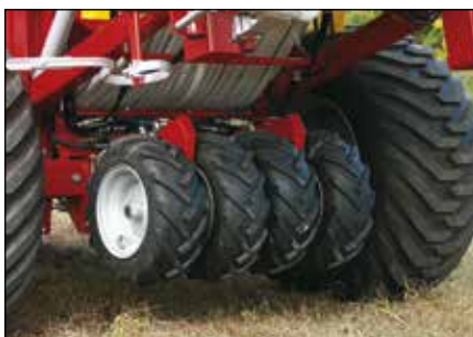
Pakning mellem traktorens hjul foretages med hydraulisk belastet mellempakker, placeret mellem de store lavtryksdæk.
