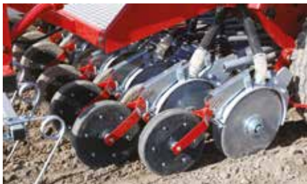
Disc dublu (DR) cu rotile de tasare din cauciuc (optional)
