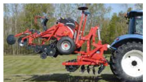
Sistem hidraulic de cuplare pentru lucrul in combinatie.
