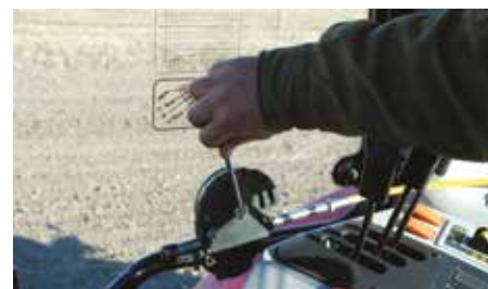
Bezstopniowa regulacja dawki wysiewu bezpośrednio z kabiny ciągnika.
