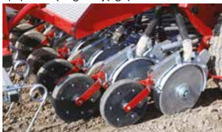
Redlica tarczowa podwójna typu DR z rolką prowadzącą.
