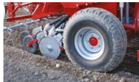
Dokładny i niezawodny system dawkowania nasion napędzany przez duże koła.
