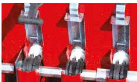
Precyzyjne wkładki dla drobnych nasion redukują dawkę wysiewu.
