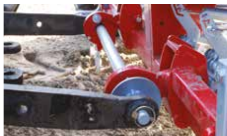
Szybkoczep ułatwiający sprzężenie (opcja).
