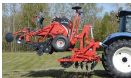
Hydrauliczny układ zawieszania umożliwia zawieszenie siewnika na kultywatorze.
