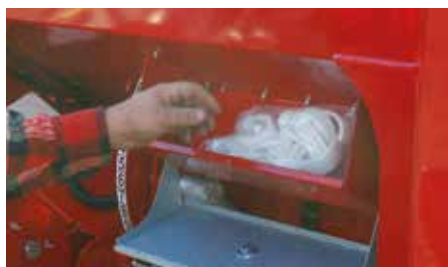
Zintegrowana skrzynka na narzędzia umożliwi przechowywanie drobnych elementów wyposażenia siewnika, części zamiennych, itp.
