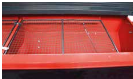
Sito zbiornika na nasiona.
