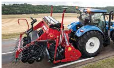
Ciężar siewnika jest przenoszony na wał zagęszczający kultywatora.
