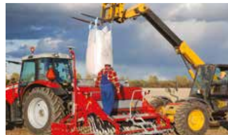
Łatwe napełnianie zbiornika na nasiona worków typu BIG BAG.
