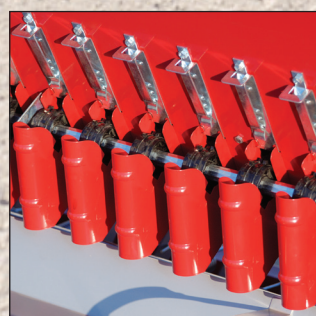
Pontos magadagolás bütykös vetőelemekkel.
