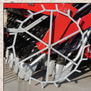
A nagyméretű járókerék minden körülmény mellett stabil fordulatszámú hajtást biztosít.
