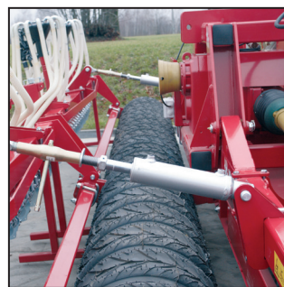
Csoroszlyaemelő hidraulikarendszer az NCS 4100-5100 típusokhoz (opcionális).
