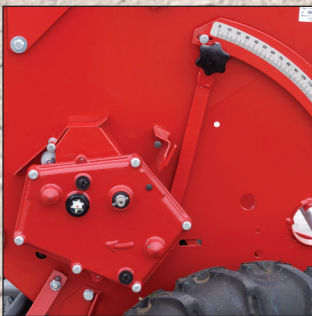
Fokozatmentes állítást lehetővé tevő Vario-K váltómű.
