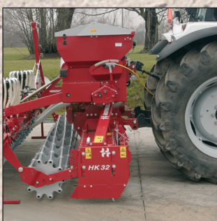
A nagy befogadóképességű magtartály súlypontja alacsonyban, a traktorhoz közel helyezkedik el.
