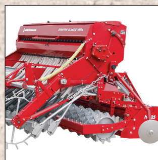
A gép súlypontja közel esik a traktorhoz.
