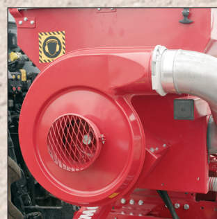
Hidraulikus vagy TLT hajtású ventilátor állítja elő a légáramot.
