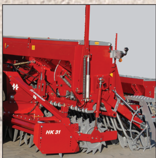
A vetőegység súlyát a talajfelszín elmunkáló egység hordozza. A vetési mélység a tömörítő henger helyzetéhez viszonyítva állítható be.
