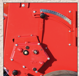
Fokozatmentes állítást biztosító Vario-K váltómű.
