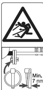
**Auf Abnutzung der Sicherungssplinte achten. Sofortiger Austausch bei Stärke unter 7mm!**
