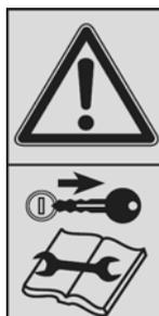
**Vor Wartungs-, Reparatur- und Instandsetzungsmaßnahmen Antrieb und Motor ausstellen und Schlüssel abziehen!**
