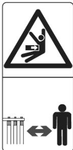
**Ausreichend Sicherheitsabstand zu rotierenden Teilen der Maschine einhalten!**
