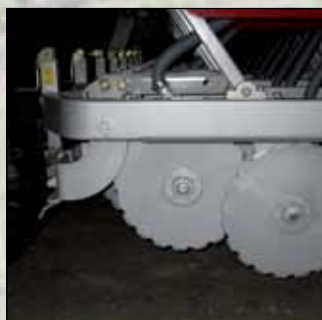
Redlice nawozowe mogą być niezależnie unoszone (wersja Combi).
