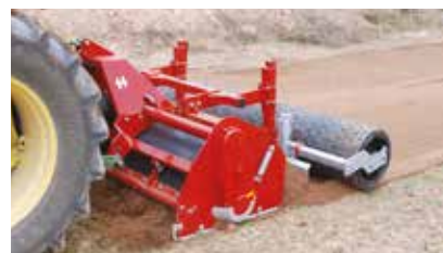
Gumowy kadłub Flexi-Top absorbuje uderzenia i umożliwia pracę w mokrej glebie.
