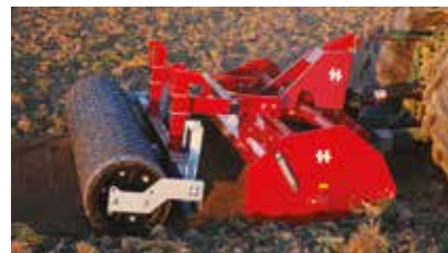
Płyta wyrównująca pomaga przygotować idealne pole pod zasiew.
