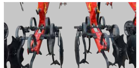
Sekcja jednego rzędu z pięcioma zębami do rozstawu rzędów od 55 - 80 cm.
