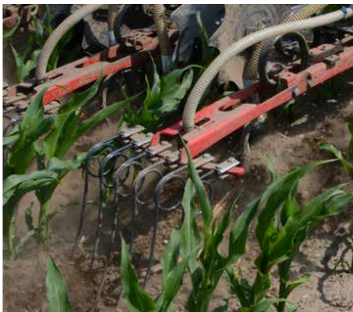
Prosty i solidny zagarniacz, który jednocześnie chroni płytę rozprowadzającą siewnika FS Seeder.
