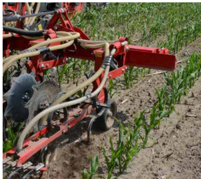
Sekcje czyszczące z oryginalnymi zębami i redliczkami Kongskilde oraz obrotowe tarcze ochraniające rośliny zapewniają optymalne czyszczenie.
