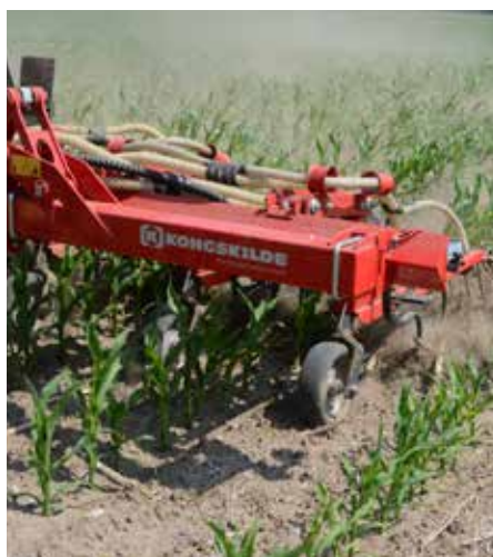
Sterowanie za pomocą kamery zwiększa wydajność dzięki zwiększonej prędkości.
