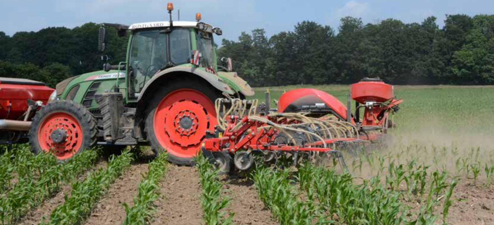
VCO-I z sekcji kontroli - zewnętrzny odcinek z lewej strony jest podniesiona
