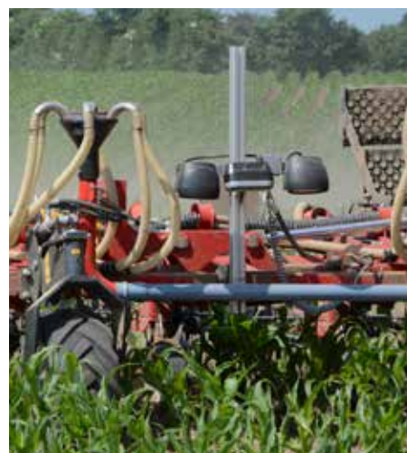
Kąt i wysokość umieszczenia kamery stereoskopowej można dostosować do stadium uprawy.
