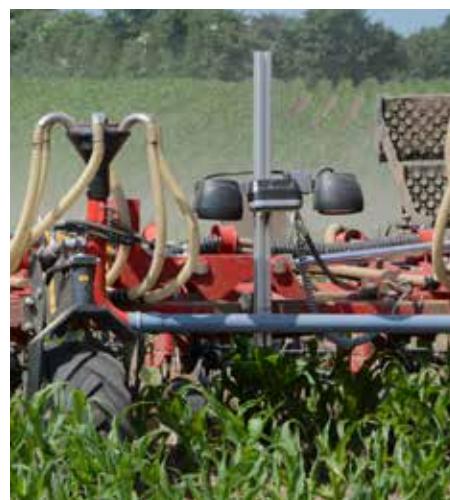
Stereokamerans höjd och vinkel kan anpassas till grödans utvecklingsstadium.
