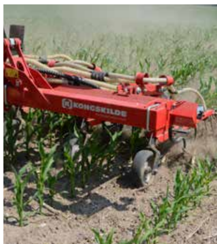
Kamerastyrning ökar kapaciteten med ökad körhastighet.
