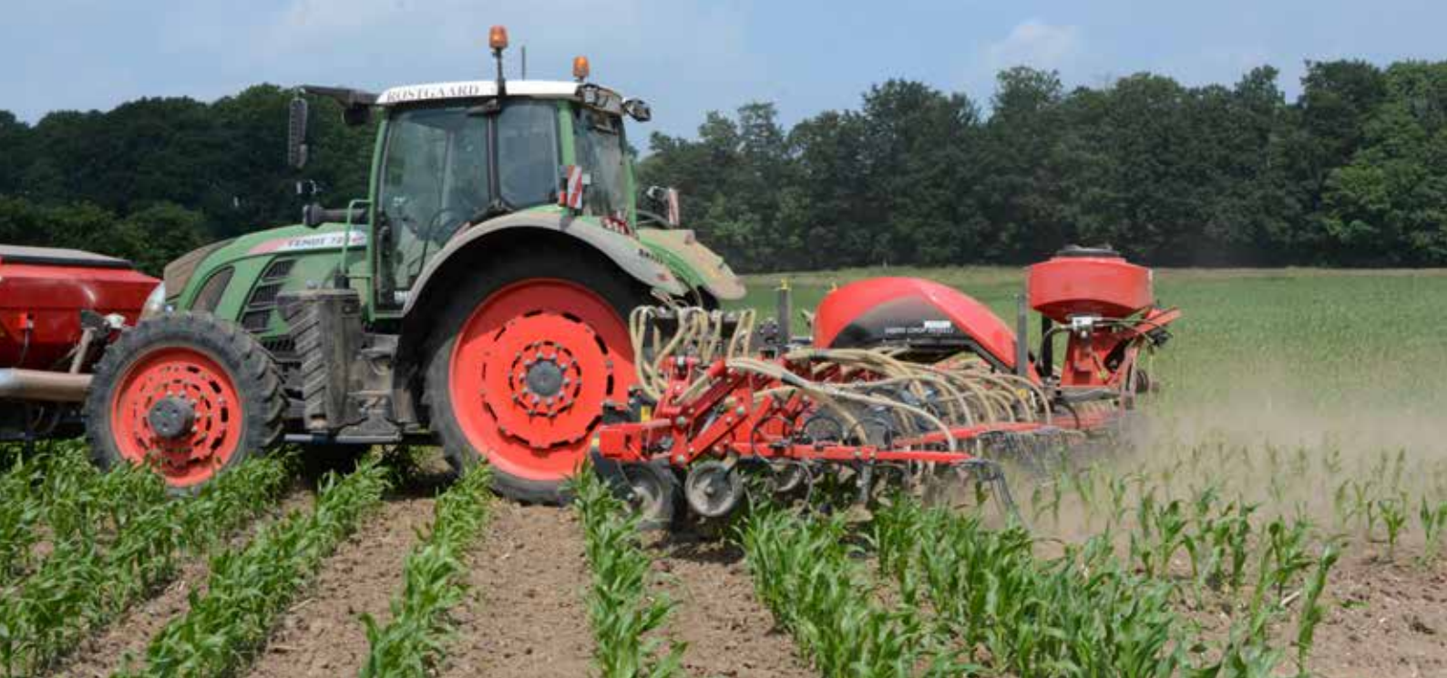
VCO-I med sektionsskontroll – yttersta sektionen till vänster är upplyft.
