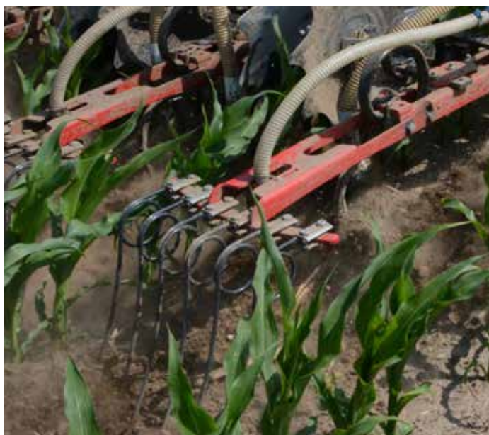
Enkel och robust efterharv som samtidigt skyddar spridarplattan för FS Seeder.
