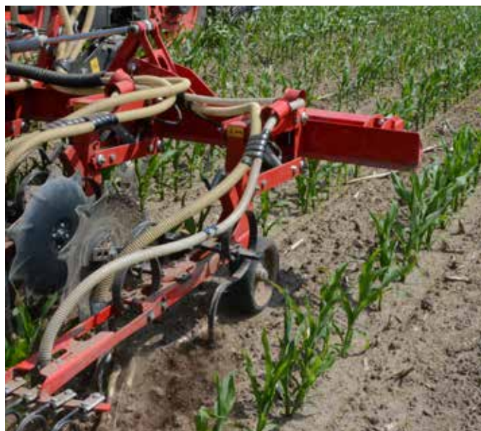
Renssektioner med Kongskilde original pinnar och skär, samt roterande skyddstallrikar säkrar optimal rensning.
