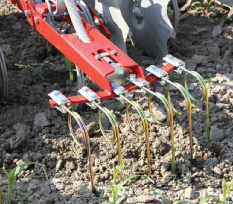
Jälkiäes viimeistelee harausjäljen ja jättää rikkakasvit maan pinnalle kuivumaan
