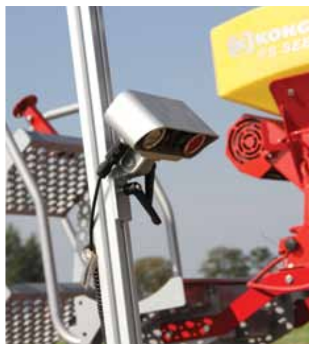
Stereokameran korkeutta ja seurantakulmaa voidaan säätää viljelykasvin kasvuvaiheen ja koon mukaan.
