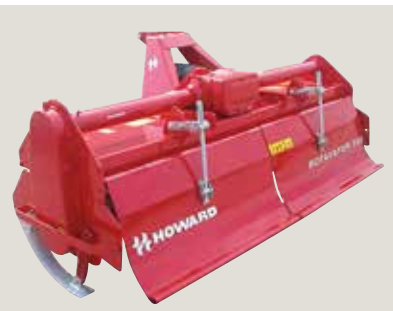
Langt fjederbelastet bagskjold giver en perfekt jordoverflade.
