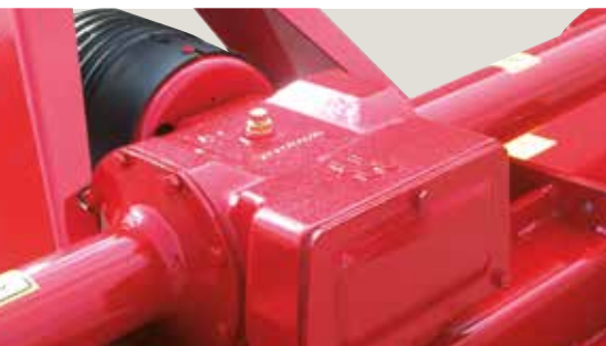
Standard 4 trins gearkasse. Hastigheden tilpasses efter den ønskede bearbejdningsgrad.
