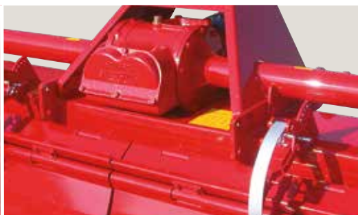
Forstærket 4 trins gearkasse for redskaber med 205 cm og 305 cm arbejdsbredde. For traktorer op til 125 hk.
