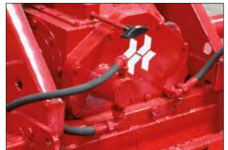
Rotavator 700S-D gearkasse. Udvendt gearskifte og olie kølingssystem.
