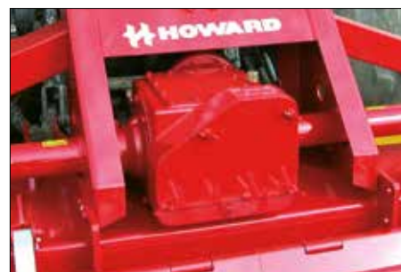
R600S-S. 4 trins gearkasse til hårdt arbejde. Denne model kan bruges til traktorer op til 180 hk.
