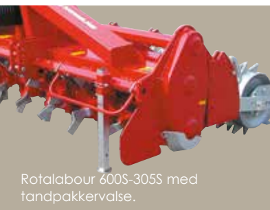
Rotor RL (to bolte): Til let jord-bearbejdning (markedsføres ikke i DK).
