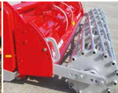
Kompakt dybdekontrollsystem for støttehjul eller pakkervalse.
