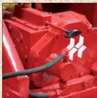
Rotavator 700X-D. De 3-snelhedenschakelkast met oliekoeling, geschikt voor tractoren tot 162 kW (220 pk).
