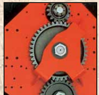
Tandwiel zijaandrijving met Y-vormige assteun.
