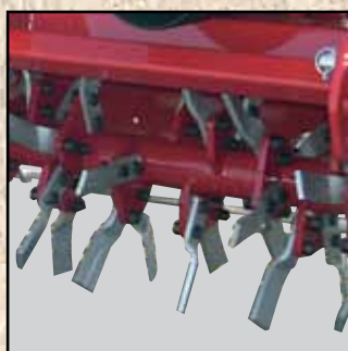
Rotor RL. Mes bevestigd met 2 bouten aan flens.
