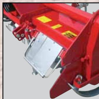
Verstelbare CE afscherming. Aan de vierkante koker kunnen eenvoudig steunwielen, sporenwissers etc. gemonteerd worden.
