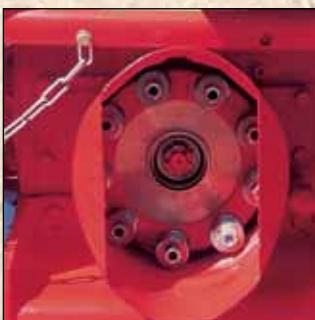
Slipkoppeling met sinter-bronsplaten voor intensief gebruik.
