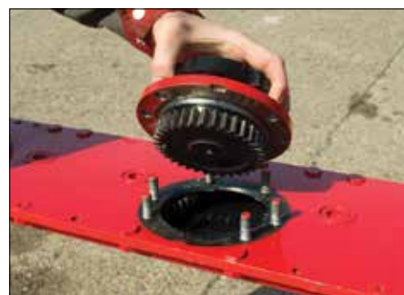
Bij de Top Service maaibalken is controle of vervangen van lagers of tandwielen op elke schijf mogelijk.
