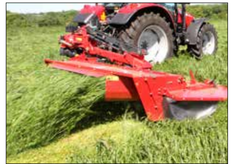
De GXS-P Top Dry wordt zonder gereedschap ingeschakeld en is perfect voor effectief breed afleggen.
