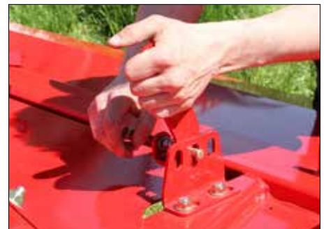
De kneusintensiteit kan zonder gereedschap worden ingesteld.
