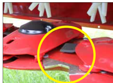
Het tegenmes is 2 mm hoger dan de bovenkant van de maaibalk.
