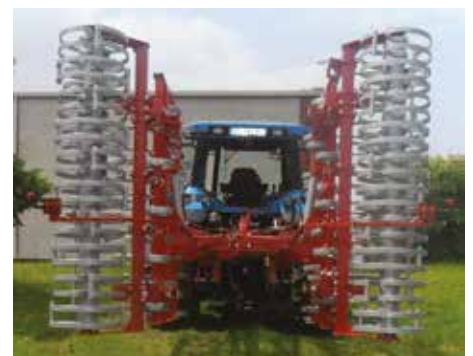
Le repliage du châssis en deux parties permet une largeur de transport de 3.0m.
