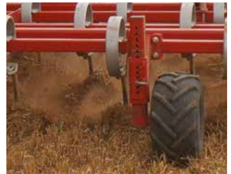
Les roues basses pression permettent d'assurer la précision de la profondeur de travail.
