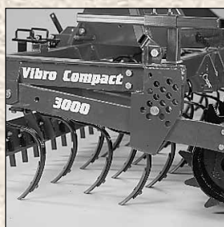
Réglage de la profondeur par butées
