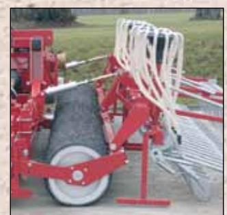
El montaje del tren de siembra sobre el rodillo del preparador asegura una profundidad de siembra muy precisa.
