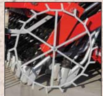
La rueda de gran diámetro asegura una transmisión fiable en todo tipo de condiciones.
