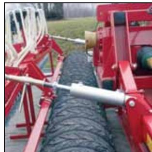
*Control hidraulico de la seccion de siembra.*
