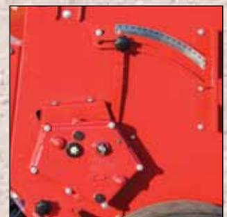
Transmisión Vario-K de infinitas posiciones para ajustar la dosis de siembra.
