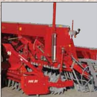
El peso de la sembradora descansa sobre el rodillo del preparador. La profundidad de siembra se regula en base a la posición del rodillo.
