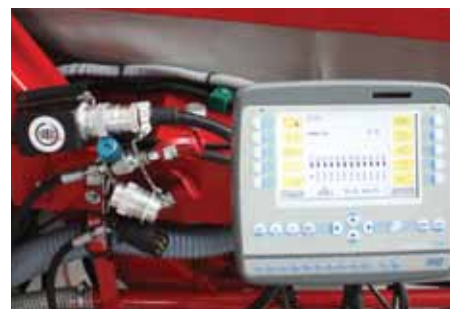
Conexiones ISOBUS y el monitor estándar Field-Operator 300.
