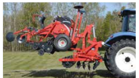
Enchance hidráulico para montar la sembradora sobre del cultivador.
