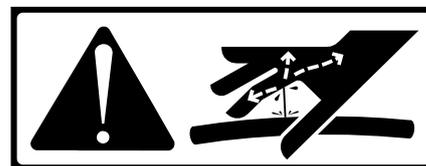
Hydraulikschläuche sollen nur an die Steuerventile des Schleppers angeschlossen werden, wenn der Schlepper und die Maschine drucklos sind. Wenn die Schlepperhydraulik aktiviert ist, können unkontrollierte Bewegungen entstehen, die Folgeschäden verursachen können.
