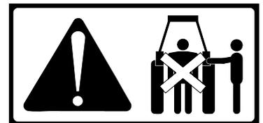
Vergewissern Sie sich, dass die Gelenkwelle korrekt anmontiert ist, d.h. der Sicherungsstift hat Eingriff und die Ketten der Schutzvorrichtung sind an beiden Seiten befestigt.
