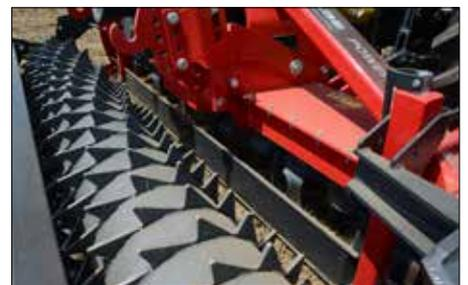
Hintere Planierschiene am Walzenarm tiefengeführt.
