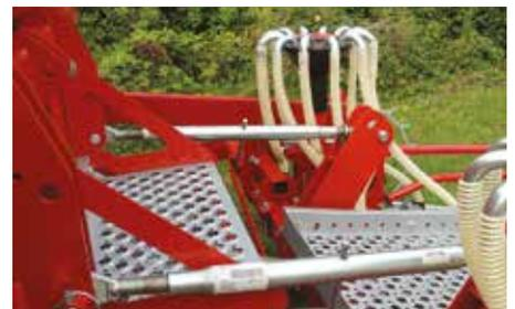
Die Saattiefe lässt sich über Spindeln am oberen Koppelpunkt der Säschiene einstellen.
