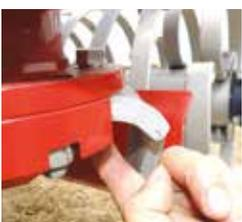
Einfache Entfernung des Bolzens, der den Zinken sichert.
