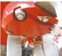
Sicherungsklappsplint am unteren Kreiselwellenflansch.
