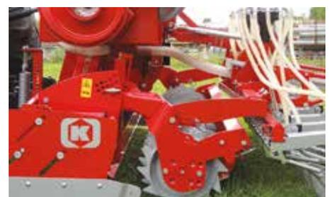
Die im Parallelogramm geführte Säschiene ermöglicht das Verändern der Arbeitstiefe ohne die Saattiefe nachjustieren zu müssen.
