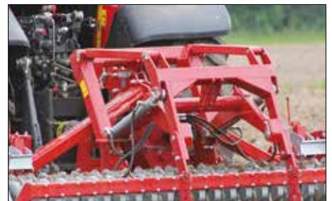
Heavy duty Hubwerk mit 3.5 t Hubkraft.
