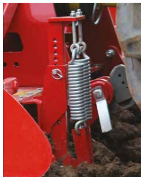
Spurlockerer mit Steinsicherung.
