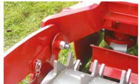
Schnelles An- und Abkoppeln der Säschiene von der Nachläuferwalze.
