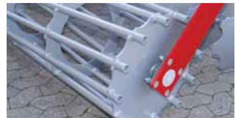
Rørpakkervalsen er egnet til mellem og lette jordtyper.
