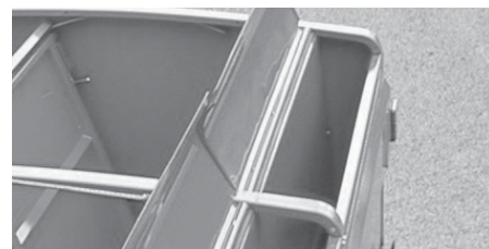
Såkasse for græsfrø er integreret i den store beholder på HT 3000 S og HT 4000 S.
