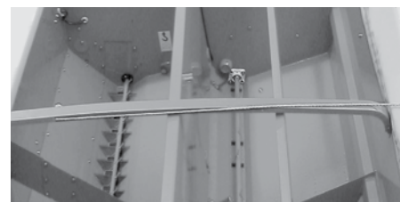
HT 3000 S og HT 4000 S har justerbar skillevæg i såkassen og omrører i begge beholdere.
