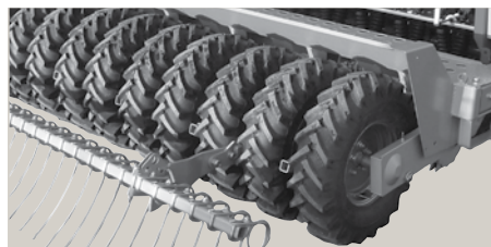
De patenterede pakkerhjul er monteret i 0,5 m sektioner.
