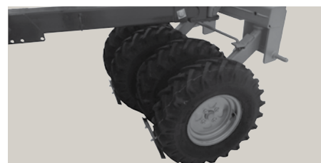
Combiseed HT kan udstyres med mellemhjulspakker til pakning af jorden imellem traktorhjulene.
