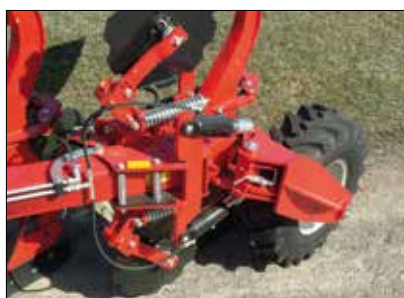
Hydraulisk dybderegulering til ovenstående combi-hjul
