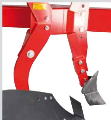
Springbolt: 16 mm 10.9 bolt-kvalitet, brydes ved en kraft på 4.000 kg
