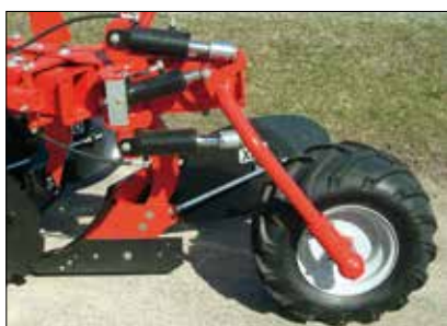
Hydraulisk dybderegulering til ovenstående hjul
