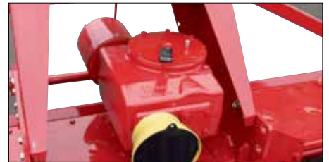
Tre trins gear med håndtag og bagudvendt PTO.
