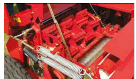
Der er meget let adgang til knivrotoren, tuden skal blot vippes ned.
