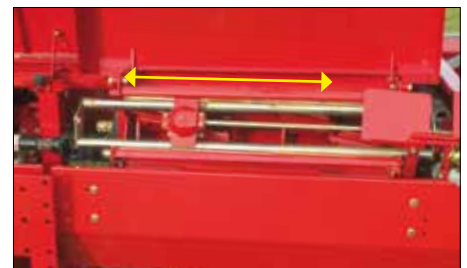
Slibning af knive er utrolig enkelt. Omløbsretningen af rotoren ændres og slibestenen trækkes frem og tilbage.
