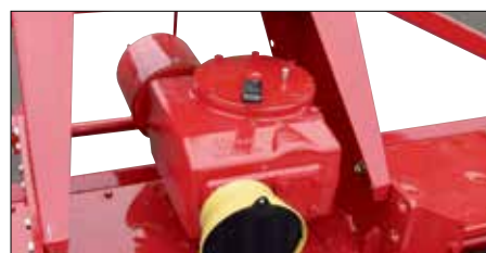
Boîte à levier 3 vitesses avec pto arrière.
