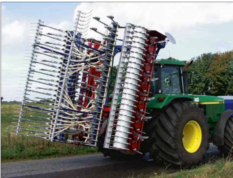
HK 31-600H avec semoir Nordsten NS 5160, repliée à largeur 3.00m.
