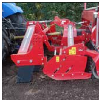
Attelage 3 points arrière avec passage prise de force.
