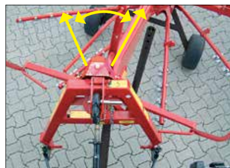
Gibljev 3-točkovni priklop je oblikovan tako, da zgrabljalnik optimalno sledi traktorju ob zavijanju.
