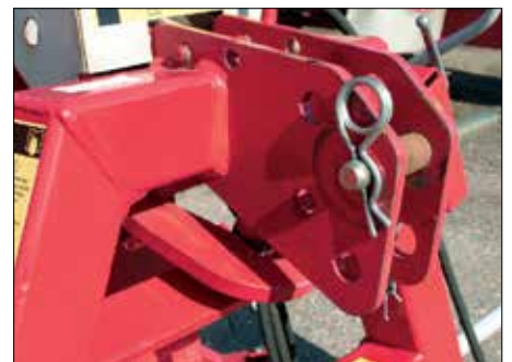
Artikuleret 3-punktsophæng er standard.
