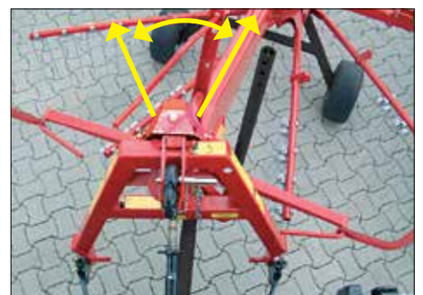
Det artikulerede 3-punktsophæng er udviklet så riven følger traktoren rundt om hjørnerne.
