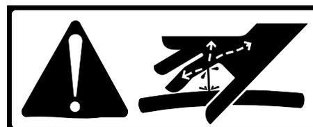
Hydrauliköl unter Druck kann in die Haut eindringen und zu gefährlichen Entzündungen führen. Deshalb immer Augen und Haut vor Ölspritzern schützen.
