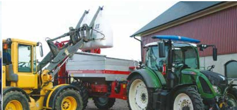
Eine federentlastete Rollplane ermöglicht schnelles und einfaches Nachfüllen. Zum Öffnen werden die Gummischlaufen gelöst; daraufhin rollt sich die Plane zusammen. Zum Schließen der Abdeckung wird an einer Schnur gezogen; zur Sicherung kommen die Gummischlaufen zum Einsatz. Sämtliche Handgriffe können von der Leiter vor dem Tank aus durchgeführt werden.
