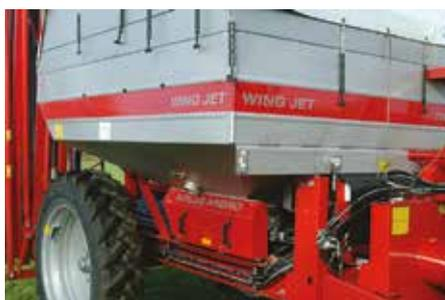
Der vom Hydrauliksystem des Traktors angetriebene hydraulische Motor lässt sich über den K-Plus-Monitor und das Proportionalventil präzise steuern. Die Fahrgeschwindigkeit wird mithilfe eines Radsensors erfasst.
