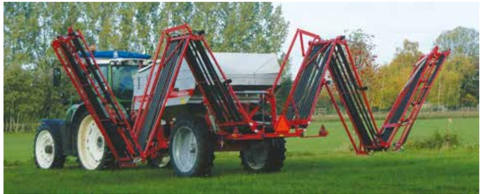
Einfaches hydraulisches Ein- und Ausklappen des Gestänges.
