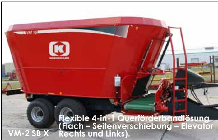
VM-2 SB X Flexible 4-in-1 Querförderbandlösung (Flach – Seitenverschiebung – Elevator Rechts und Links).
