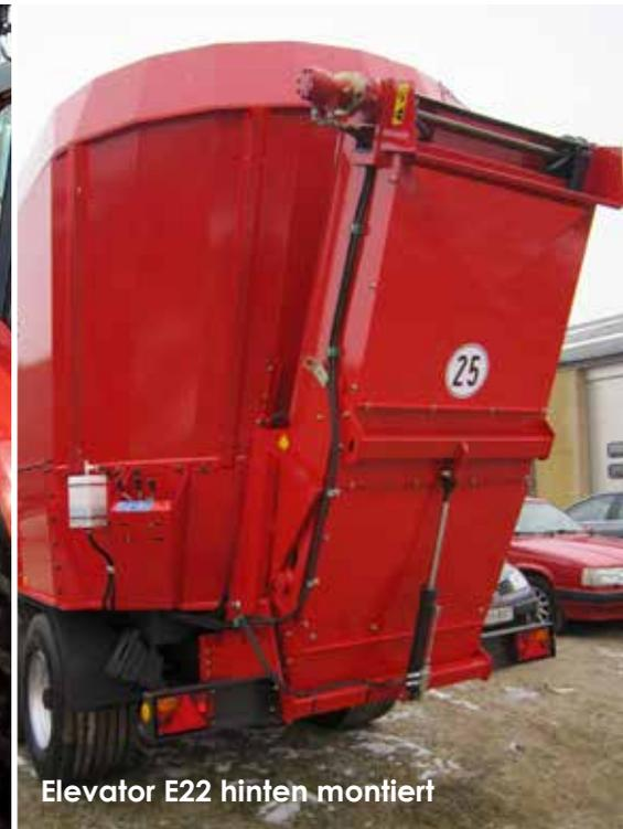
Elevator E22 hinten montiert
