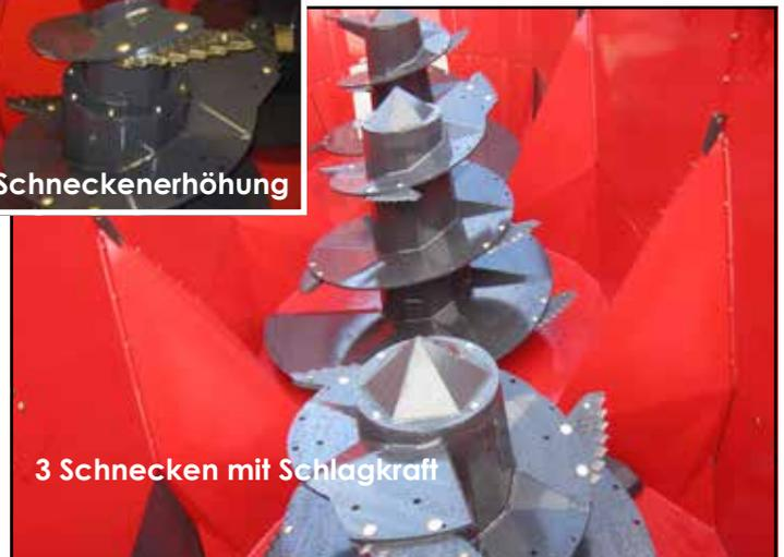
3 Schnecken mit Schlagkraft
