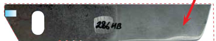
Feinkornstahl (S650) nach dem Verschleißtest
