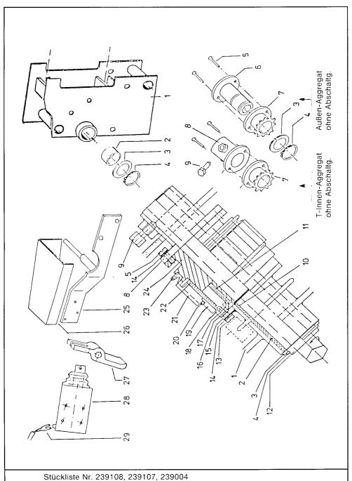
Karl BeckerErsatzteilliste Blatt Nr. H 0051Ausgabedatum: 10/91MaschinenfabrikElektromagnetische Aggregat-Abschaltung
