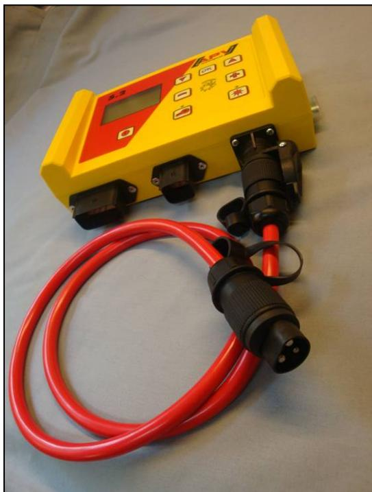
Vous pouvez raccorder le câble fourni en série directement à la prise standard tripolaire du tracteur dans la cabine. Raccordez l'autre extrémité au module de commande.
