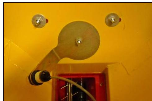
Le capteur peut également être adapté au semis en termes d'intensité. Ceci est possible grâce à la petite vis à tête fendue située derrière sur le capteur.
