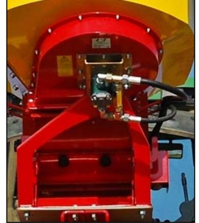
**Contenu de la livraison:** 1 HG 300 M1 avec adaptateur, 1 support et système de flexibles complet, régulateur de débit incl.
