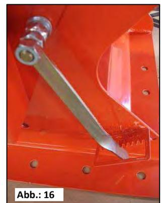
Mit der Bodenklappe wird das Gerät grundsätzlich auf das damit gestreute Saatgut eingestellt.
