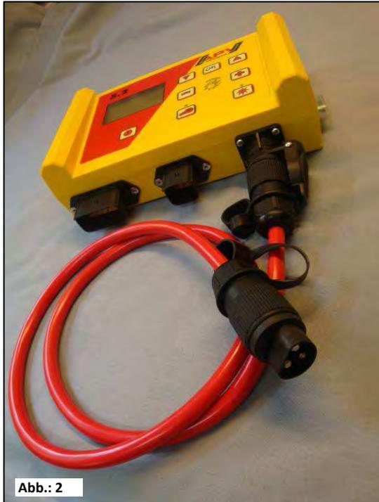
Das serienmäßig mitgelieferte Kabel können Sie direkt an die 3-polige Normsteckdose des Schleppers in der Kabine anschließen. Das andere Ende verbinden Sie mit dem Steuermodul.
