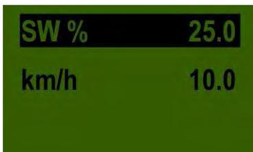
**SW %:** Eingestellte Drehzahl der Säge (in %) einzustellen durch die
