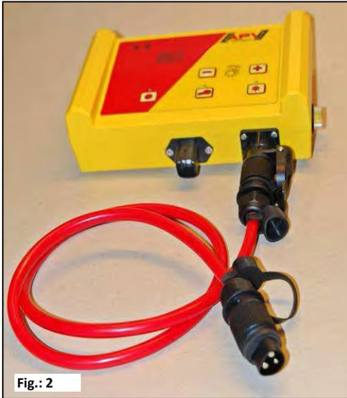
È possibile collegare il cavo di serie fornito in dotazione direttamente alla presa di corrente standard a tre poli del trattore all'interno della cabina. Collegare l'altra estremità al modulo di controllo.
