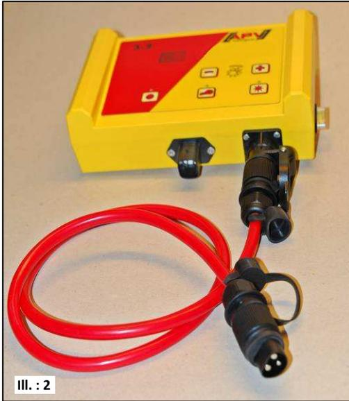
Vous pouvez raccorder le câble fourni en série directement à la prise standard tripolaire du tracteur dans la cabine. Raccordez l'autre extrémité au module de commande.
